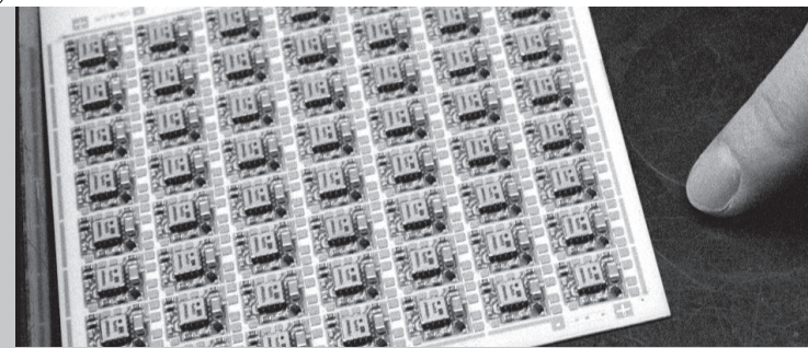
MicroHybrid: Keramische Schaltung nach der maschinellen Bestückung. © Karl-Heinz Rothenberger
